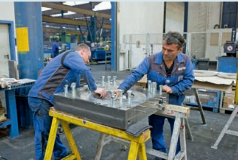
Montage (Zusammenbau) des beweglichen Sägekopfes bei der Mafa
