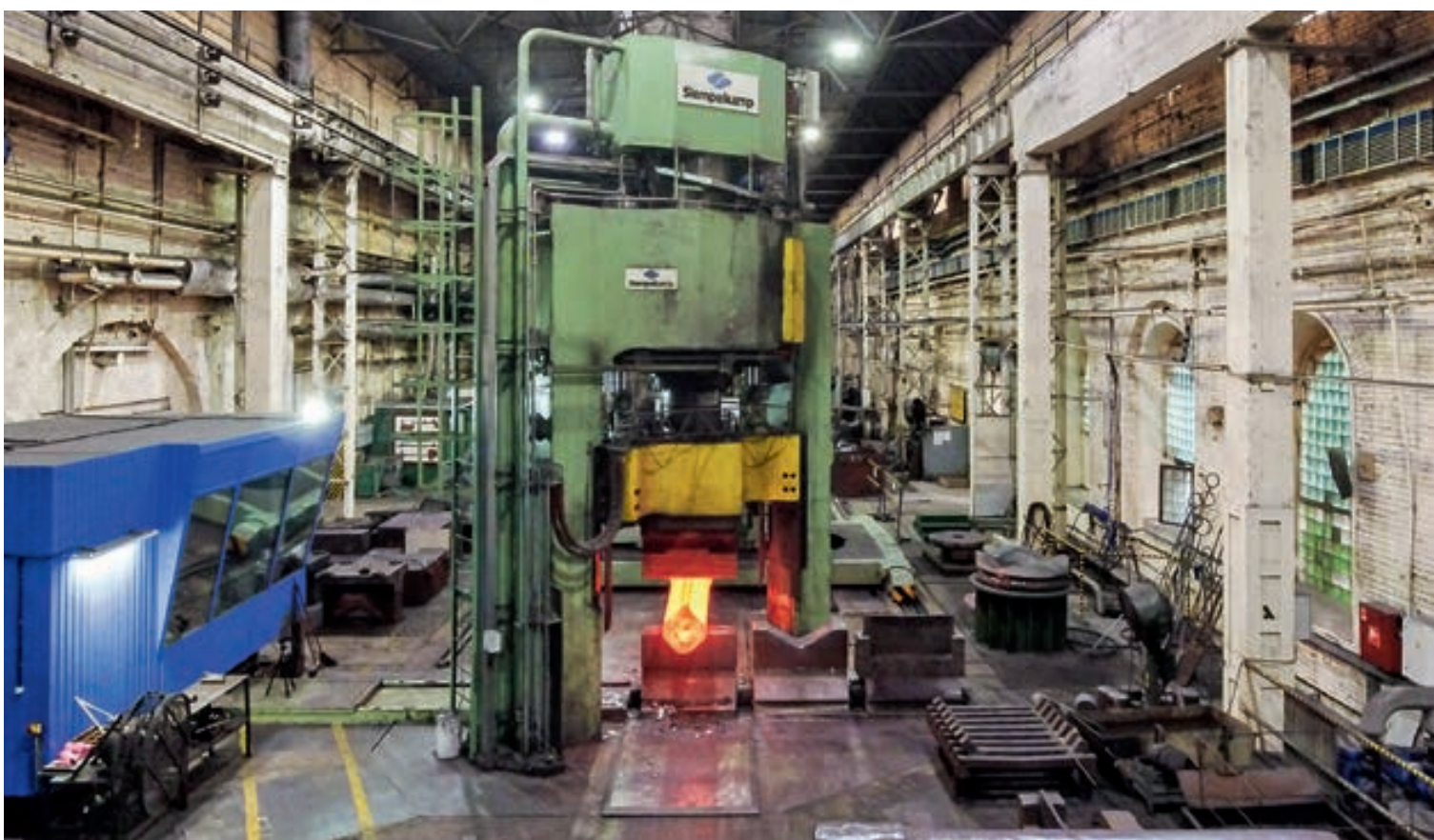
Blick in die Fertigungshalle von KMZ mit der neuen Siempelkamp-Freiformschmiedepresse beim Vierkantschmieden eines Ingots
