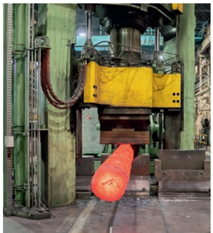
Rundschmieden durch Drehen des Rohlings zwischen den Presshüben
