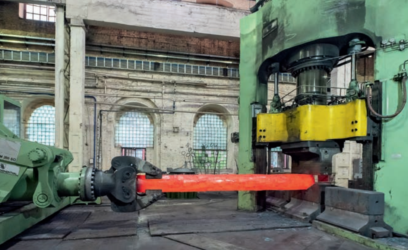
Schmieden und Längen des durch den Manipulator geführten Rohlings
